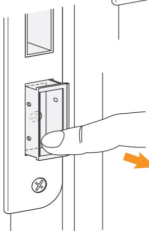
3) 図1を参考に、ラッチ受け箱(4/2.5mm)または付属品の調整ラッチ受け箱(1.5/5mm)を使用し、取り外した逆の手順で元に戻してください。
