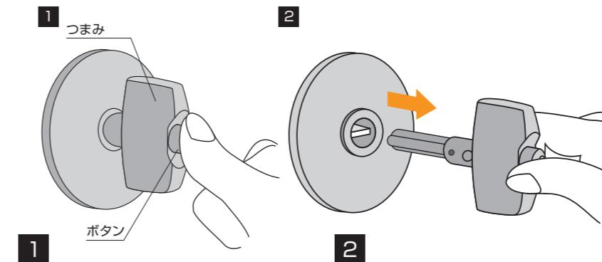
デッドboltが収納された状態で、ボタンを押し込んだまま、つまみと一緒に引き出します。
