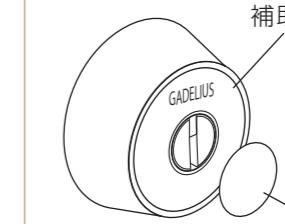
④補助錠の鍵穴保護シールを剥がして③の確認を行って下さい。
