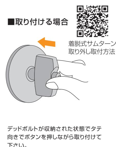
デッドboltが収納された状態でタテ向きでボタンを押しながら取り付けて下さい。
