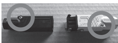
コネクタを裏返しビス をはす。 ※分解用のビスが有る
