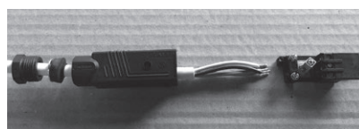
コネクタに配線を通す。 内側から1番目の切れ 込みを切取ってください。 (7φ)
